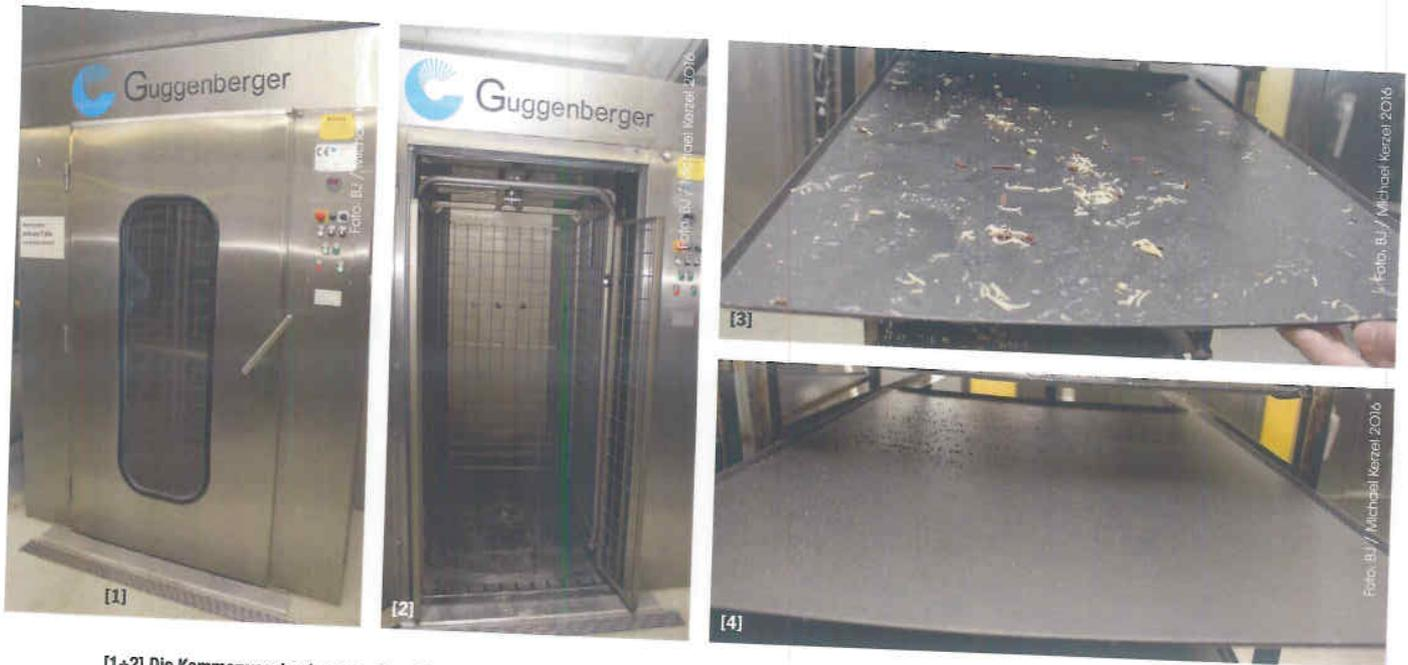
[1+2] Die Kammerwaschanlage vom Typ HSA 2000 Eco Flex von Guggenberger hat in etwa die Maße von 2,5 Metern im Quadrat. Die Maschine ist mit einer Schleudertrocknung ausgestattet. Auf dem Drehteller ist ein Washkäfig aufgebaut, in den die zu reinigenden Gegenstände in Wagen gestellt werden. [3+4] Käsereste oder auch angetrockneter Fondant werden bei den kurzen Waschgängen gereinigt. Lediglich ein paar Tropfen Wasser bleiben auf den Teflonblechen zurück.
